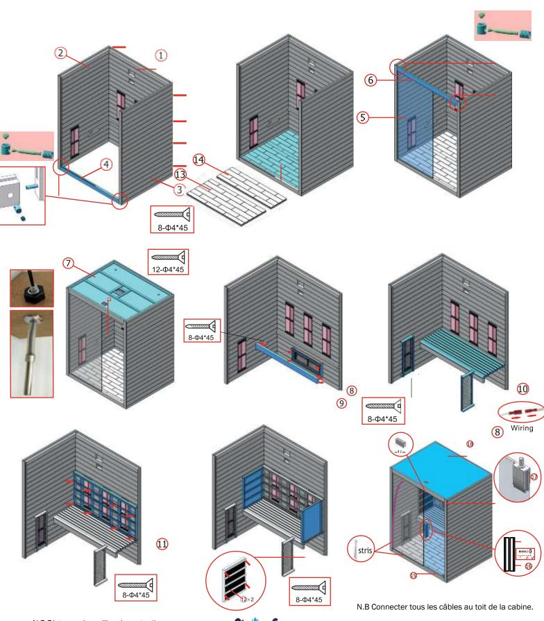
N.B Distancer les grilles de protections latérales et postéri panneaux du banc d'au moins 20mm.
