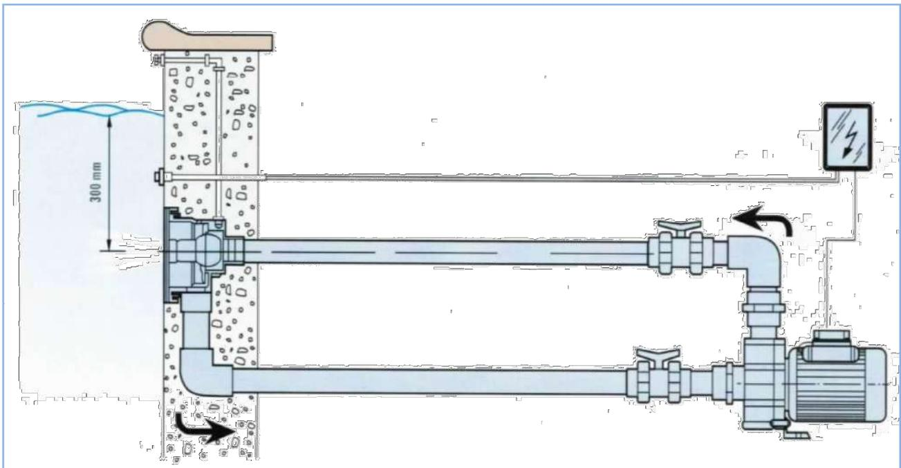
Schéma type installation pour nage à contre-courant
