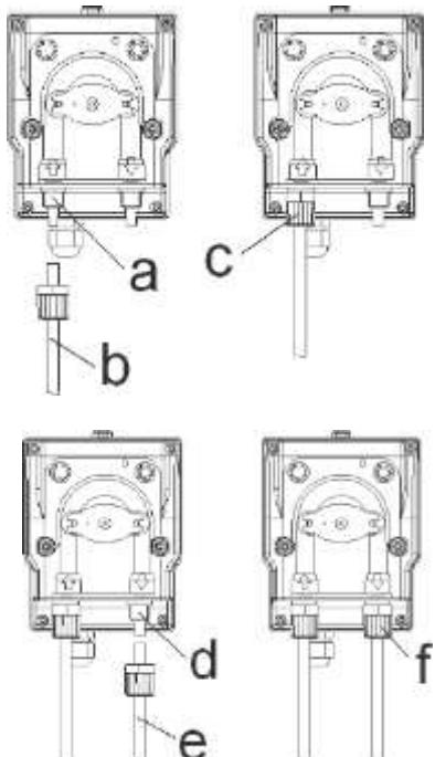
**I Aspirazione:** Collegare il tubo di aspirazione (b) al raccordo di aspirazione (a).
