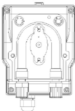
**I** Inserire il raccordo di destra nella propria sede e rimontare il coperchio avitando le due viti del frontale
