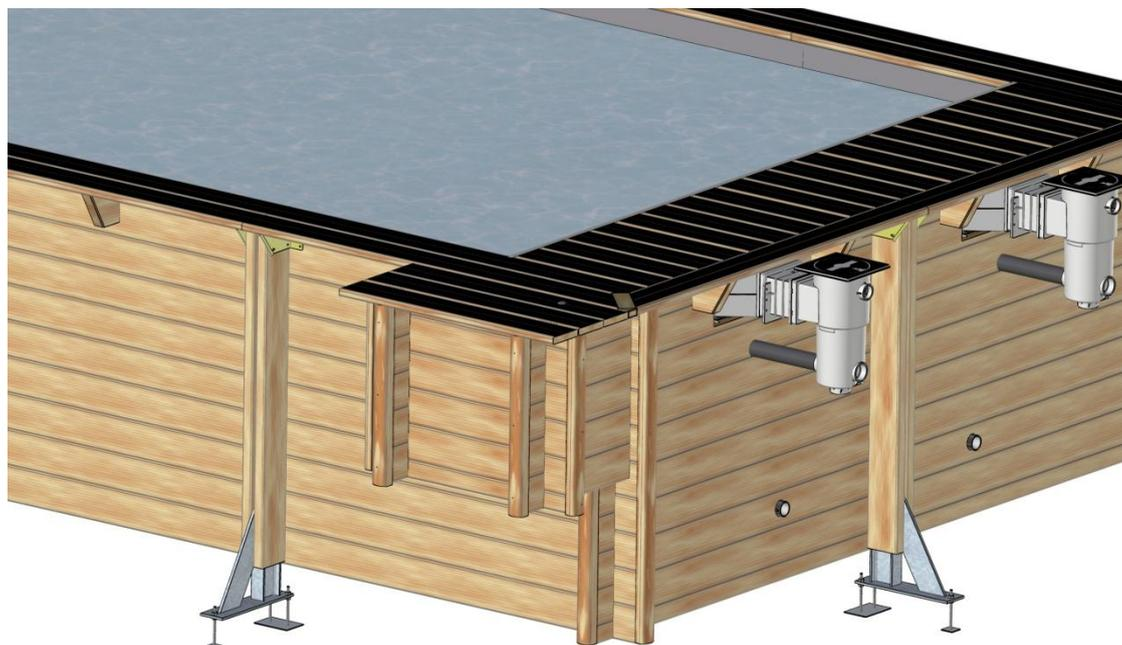
Figure 58 – Emplacement du coffre sur le bassin
