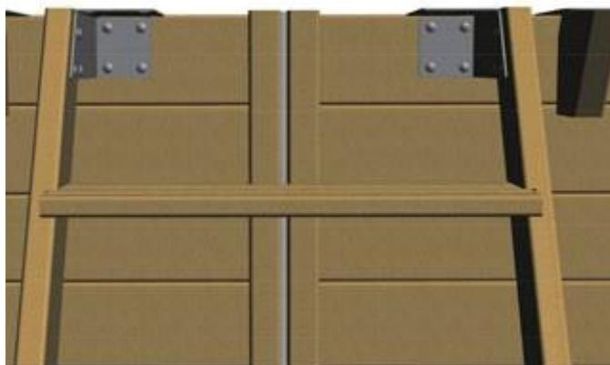
Figure 16 – Fixation de l'escalier extérieur sur le bassin
