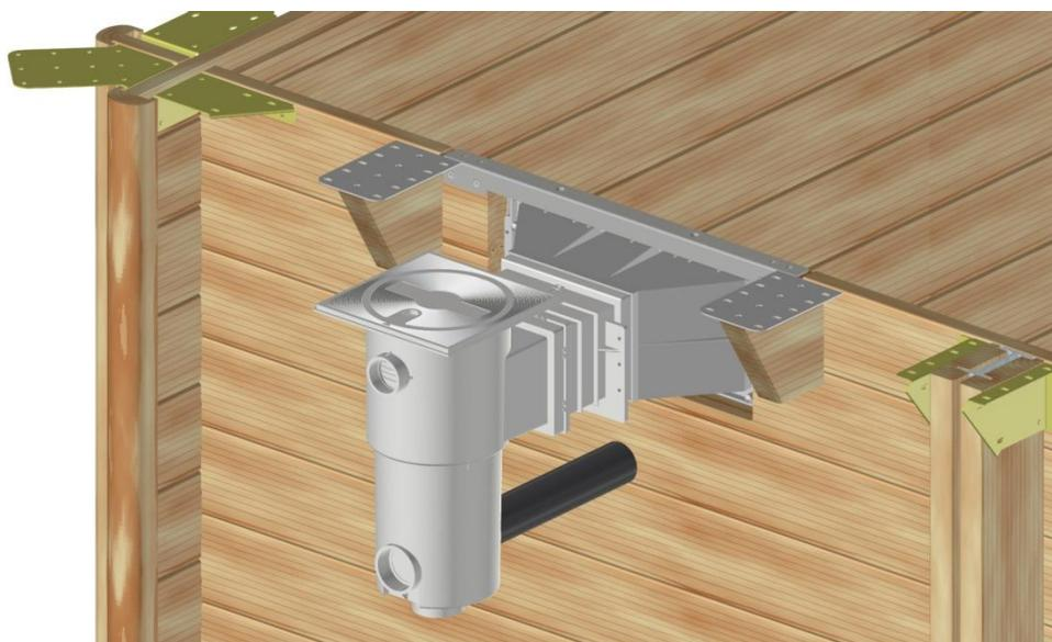
Collez les joints de skimmer sur la façade, en faisant coïncider l'emplacement des perçages du skimmer et de son joint. Le liner doit alors être posé dans les 48 heures qui suivent (*Paragraphe 10.5*). Si cela n'est pas possible, différez la pose du joint, et vous l'installerez juste avant la mise en place du revêtement d'étanchéité. Le reste de la pièce (joint et bride) sera ajouté après la pose du liner, afin d'assurer l'étanchéité au niveau du skimmer.
