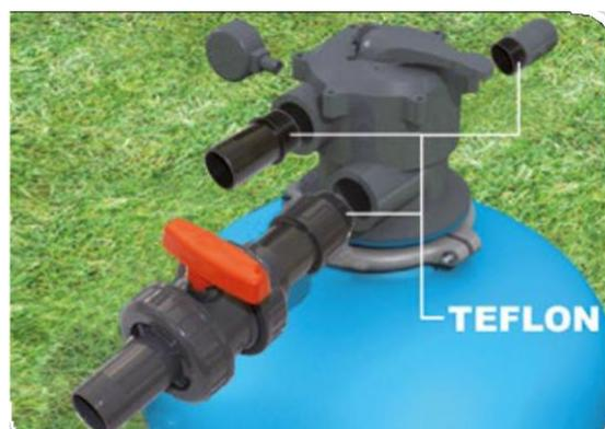
Vissez sur la vanne 6 voies le module d'isolement (K), les 2 raccords cannelés et le manomètre. Pour l'ensemble de ces vissages il est impératif de mettre du téflon.
